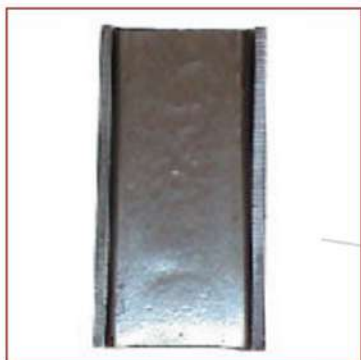
Нормальный износ, лопатка пригодна для эксплуатации
