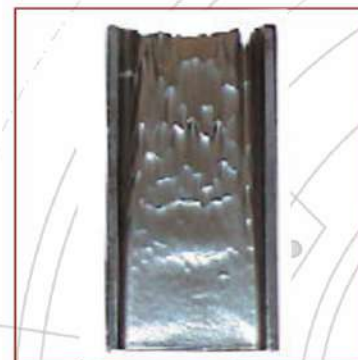
Критический износ (сквозной), требуется замена лопатки
