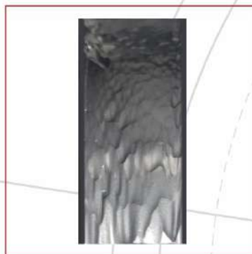
Предельный износ (износ более 50% от исходной толщины), требуется замена лопатки
